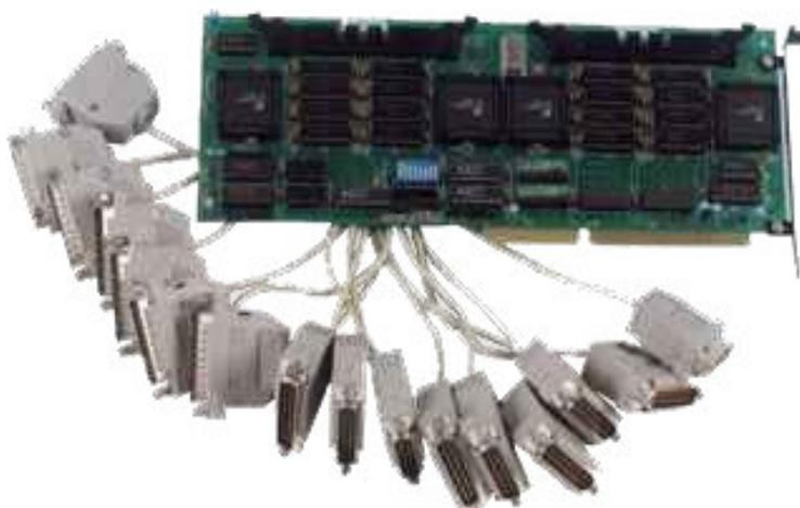
A placa NX16ARF pode ser configurada utilizando uma ou duas IRQs.
